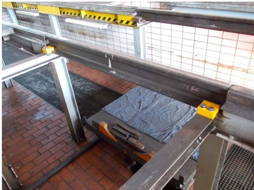
Abbildung 1: Verschraubte Sicherungsklötze an der Achssenke
